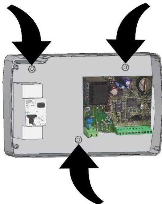
Fig. 6: Utilizzando i tre fori preesistenti fissare il fondo della scatola tramite tre viti di adeguata lunghezza in relazione allo spessore della parete su cui fissare il quadro. Interporre tra ogni vite di fissaggio ed il fondo della scatola una rondella in gomma (fornita).
