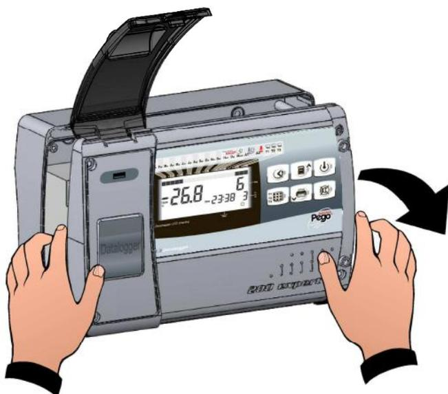
**Fig. 3:** Aprire il frontale della scatola sollevandolo e facendo scorrere le due cerniere fino a fine corsa. Flettere le cerniere e ruotare il frontale di 180° verso il basso per accedere all'interno del quadro
