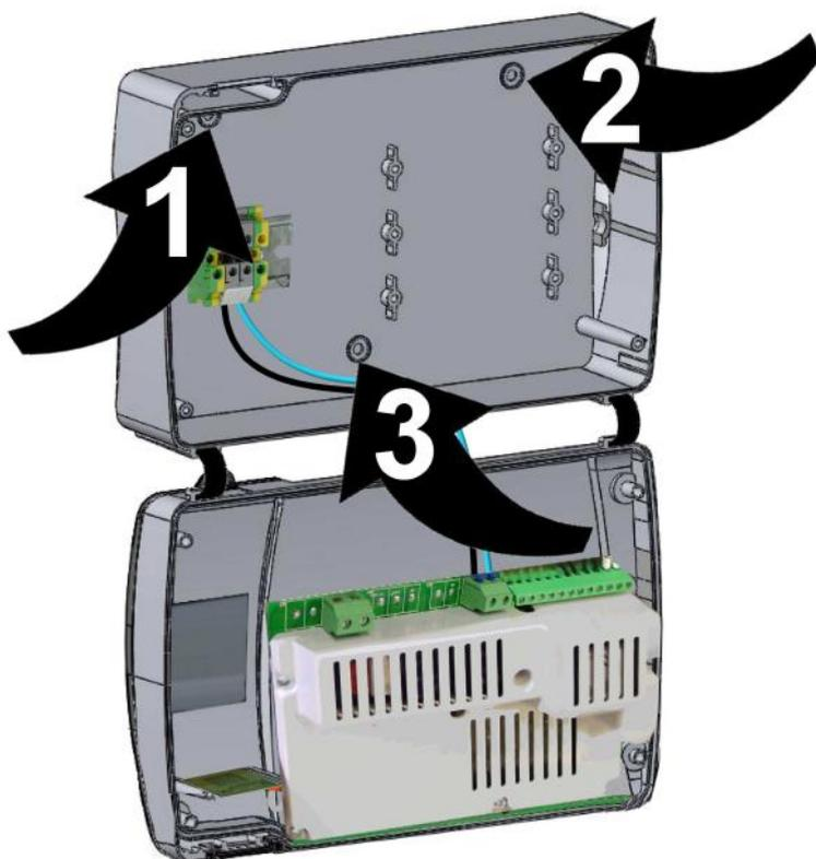
**Fig. 4:** Utilizzando i tre fori (1), (2), (3) preesistenti fissare il fondo della scatola tramite tre viti di adeguata lunghezza in relazione allo spessore della parete su cui fissare il quadro. Interporre tra ogni vite di fissaggio ed il fondo della scatola una rondella in gomma (fornita).
