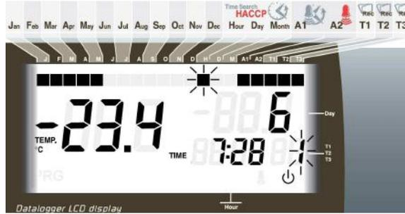
7. Con il tasto (▲) e (▼) si scorrono gli allarmi di temperatura del canale visualizzato. Lo stato dell'ingresso digitale viene visualizzato per mezzo dell'accensione del segmento a sinistra del giorno.
